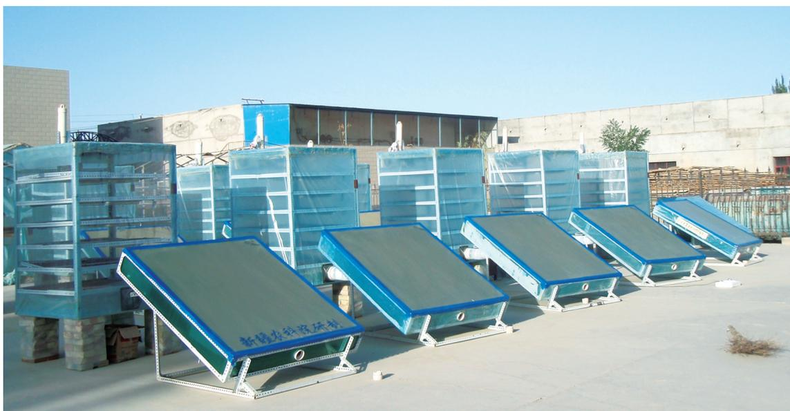
5HT-2 农副产品太阳能干制装置实体图。
