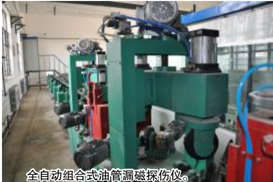
全自动组合式油管漏磁探伤仪。
