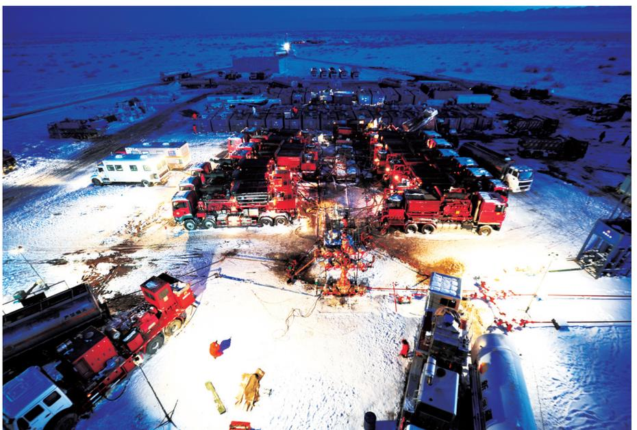
科研成果应用于砾岩油藏大规模体积压裂的现场施工照片。
