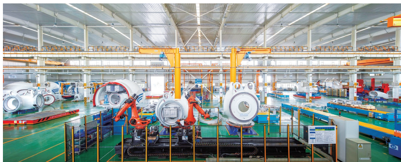
新疆金风科技股份有限公司位于新疆哈密的总装智能生产线,该生产线比传统生产线更省人力、误差更小,效率更高。
